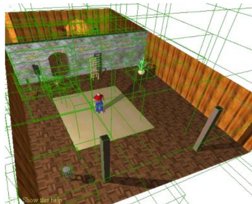
Príklad zložitejšieho delenia priestoru pomocou oktantových stromov
