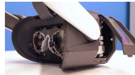
Meta headset s retinálnym (projekcia na sieťnicu) varifokálnym displejom
